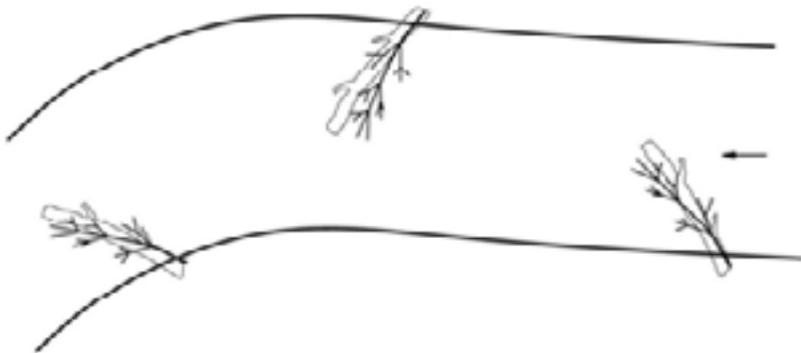
Rysunek 2.3 Drzewa nadbrzeżne ścięte w nurt rzeki i pozostawione jako deflektory inicjujące zwiększenie krętości nurtu i zróżnicowanie morfologii koryta (Działanie dodatkowe 10). Jedno z pierwszych europejskich przedsięwzięć tego typu zrealizowane w Polsce, na rzece Trzebiocha. Opracowano na podstawie: Radtke (1994)
