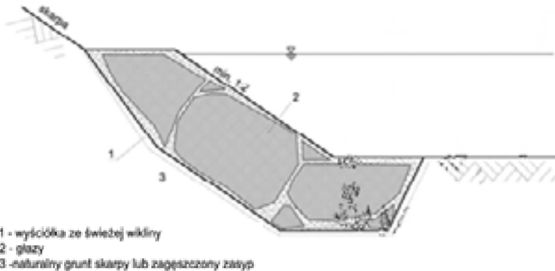
Rysunek 1.4 Ubezpieczenie z narzutu kamiennego
