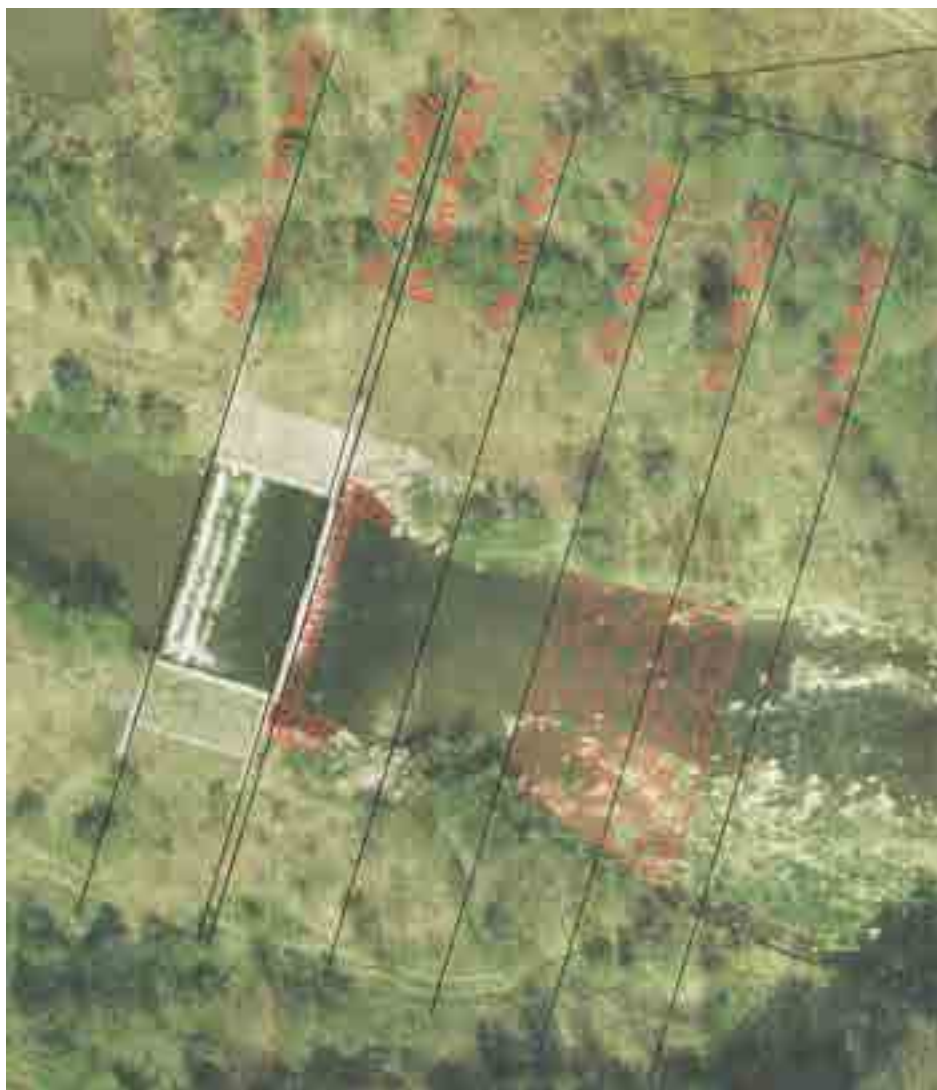
Rys. 2. Lokalizacja przekrojów z Rys. 1. na tle ortofotomapy. Kolorem czerwonym oznaczono planowane rzędne i elementy inwestycji przebudowy progów. Źródło: RZGW Kraków, Zarząd Zlewni Raby Dobczyce
